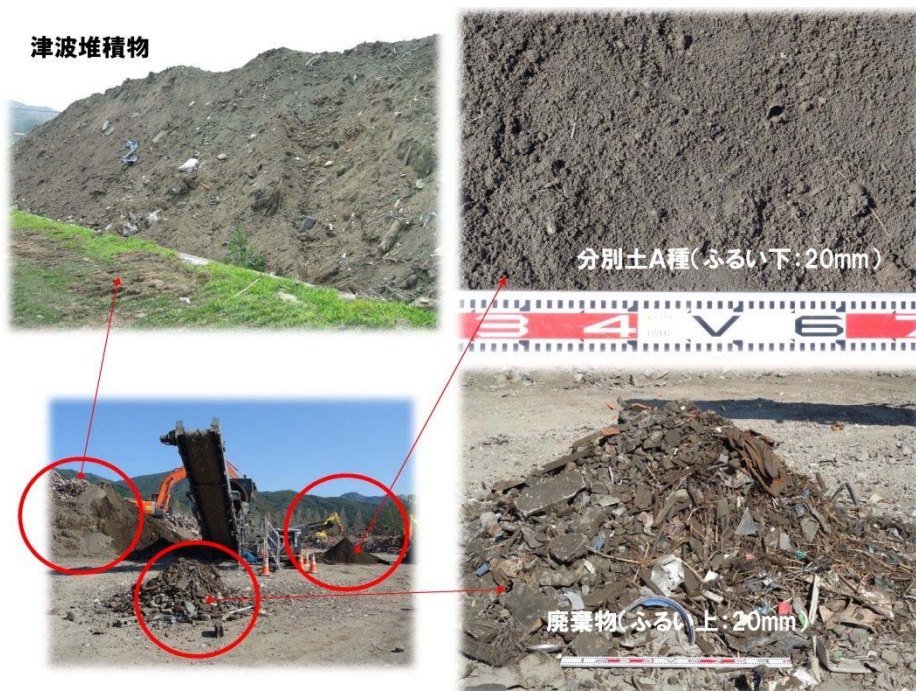
図 4-15-1 津波堆積物のふるい選別（乾式分級）の例
